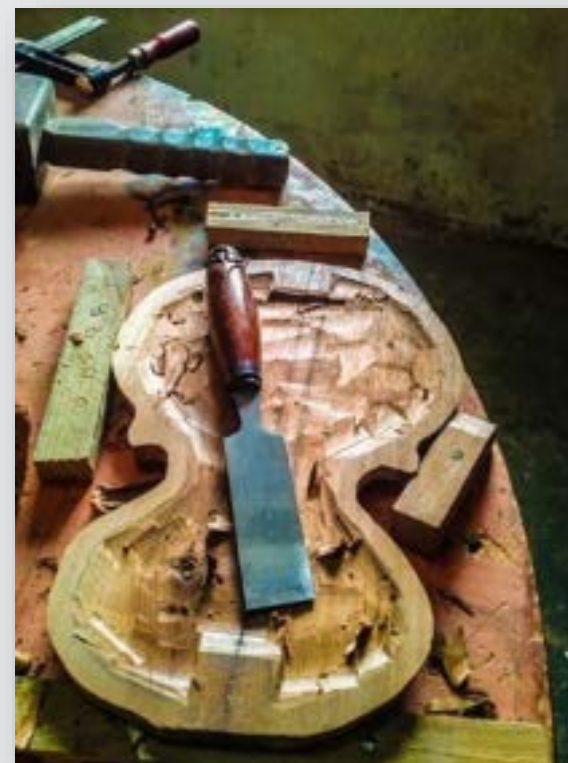
Fotografia 1 - Rabeca em fase de construção sendo confeccionada pelo Mestre Antônio Pinto. Aurora - Ceará, 02 de abril de 2015.
